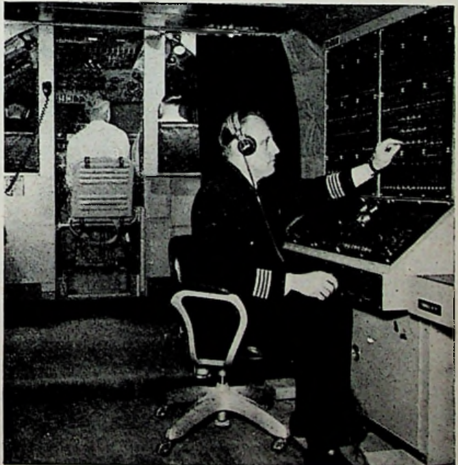
DE VLUCHTNABOOTSER VAN DE SAS - Kapitein Osten Lindberg aan het instructeurspaneel, op de achtergrond de stuurhut, welke volkomen gelijk is aan die van een Douglas DC-6B.
